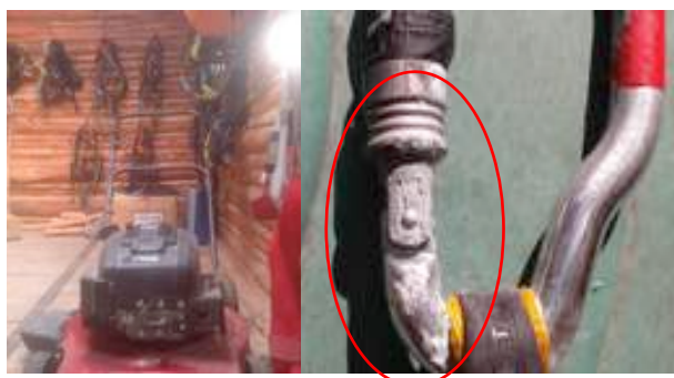
A karabiner zárszerkezete sem alkalmas laikus felhasználóknak, azonban az anyag kopásának mértéke is igen jelentős
