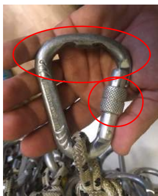
A karabiner zárszerkezete sem alkalmas laikus felhasználóknak, azonban az anyag kopásának mértéke is igen jelentős
